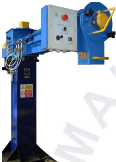
Высокоскоростные однорукавные смесители непрерывного действия с разной производительностью . Данный смесители могут использоваться как для формовки полуформ, так и для изготовления стержней по ХТС процессу.
